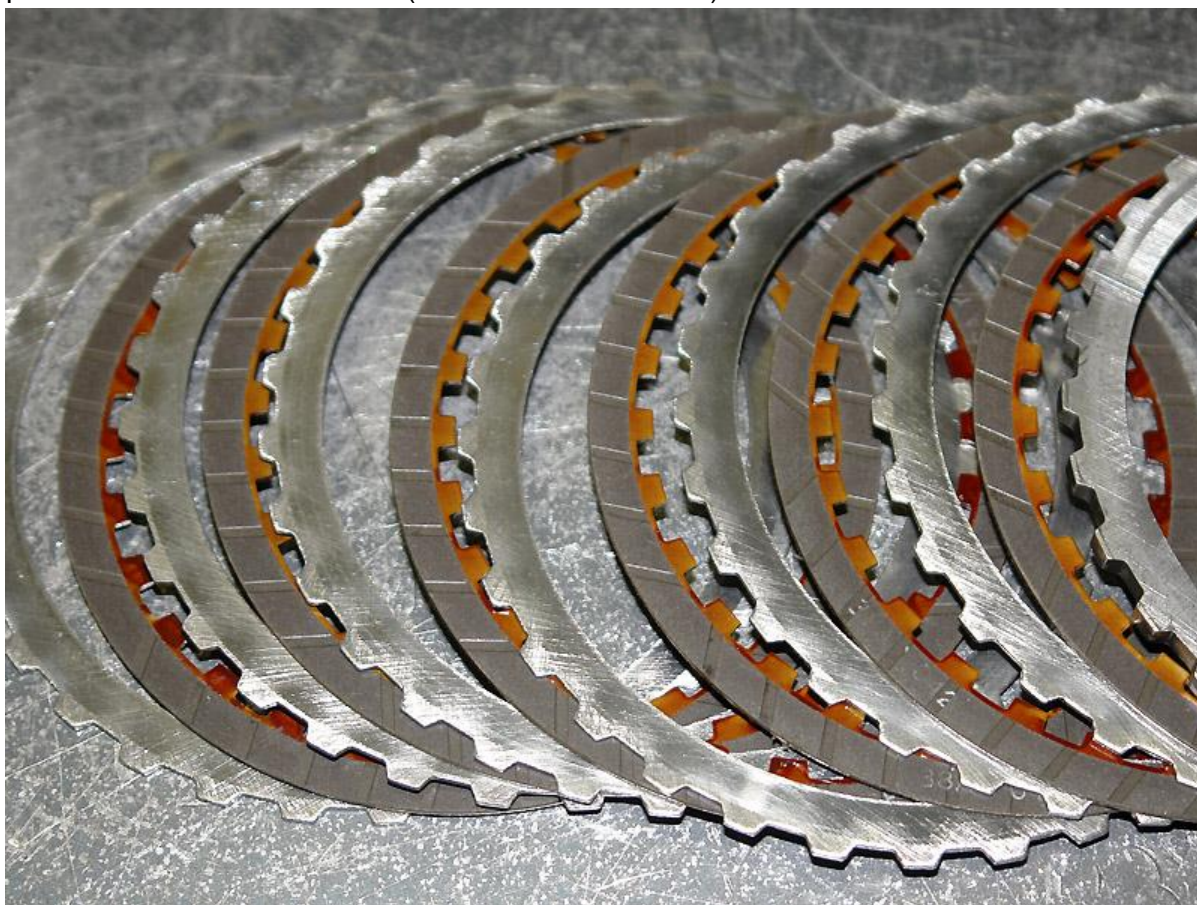
Фото № 4: Пакет фрикционных дисков сцепления К1 (вкл. на 1-3 передачах).
