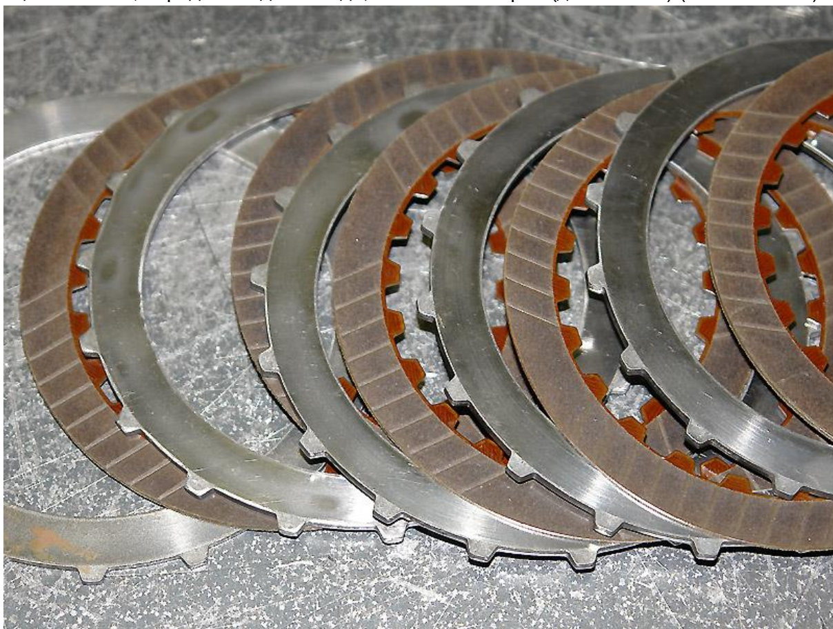
Фото № 6: Пакет фрикционных дисков сцепления К3 (вкл. на 3-5 передачах).
