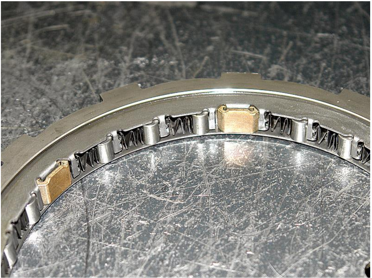
Фото № 13: Роликовый сепаратор муфты свободного хода в сборе с наружной обоймой.
