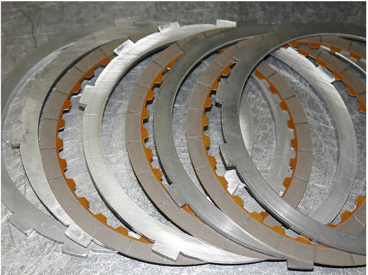
Фото № 9: Пакет фрикционных дисков тормоза В2 (вкл. на 2, 4 и 5 передачах).
