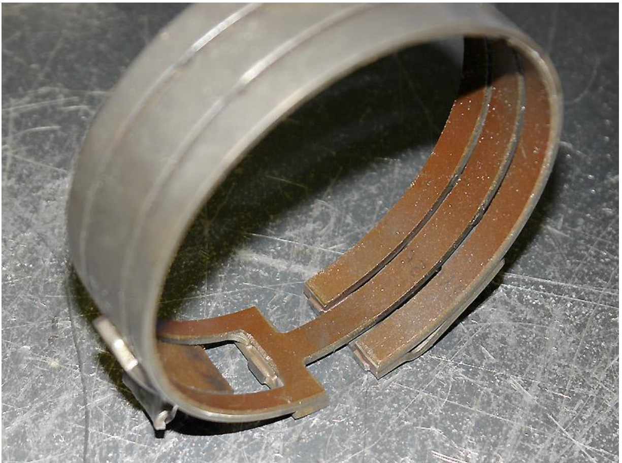
Фото № 10: Тормозная лента тормоза В3 (вкл. на передаче заднего хода).
