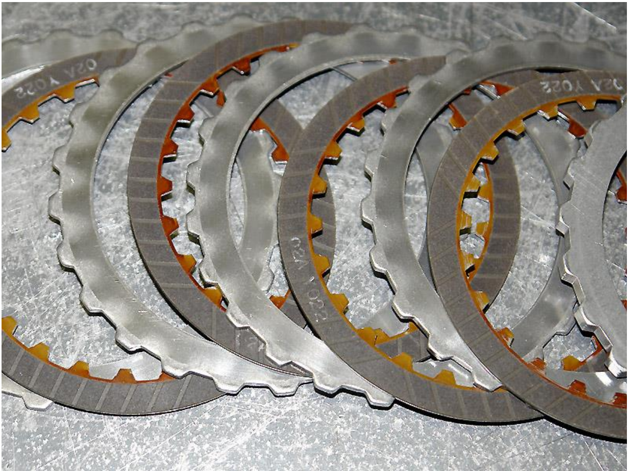
Фото № 7: Пакет фрикционных дисков сцепления K4 (вкл. на 5 передачи).
