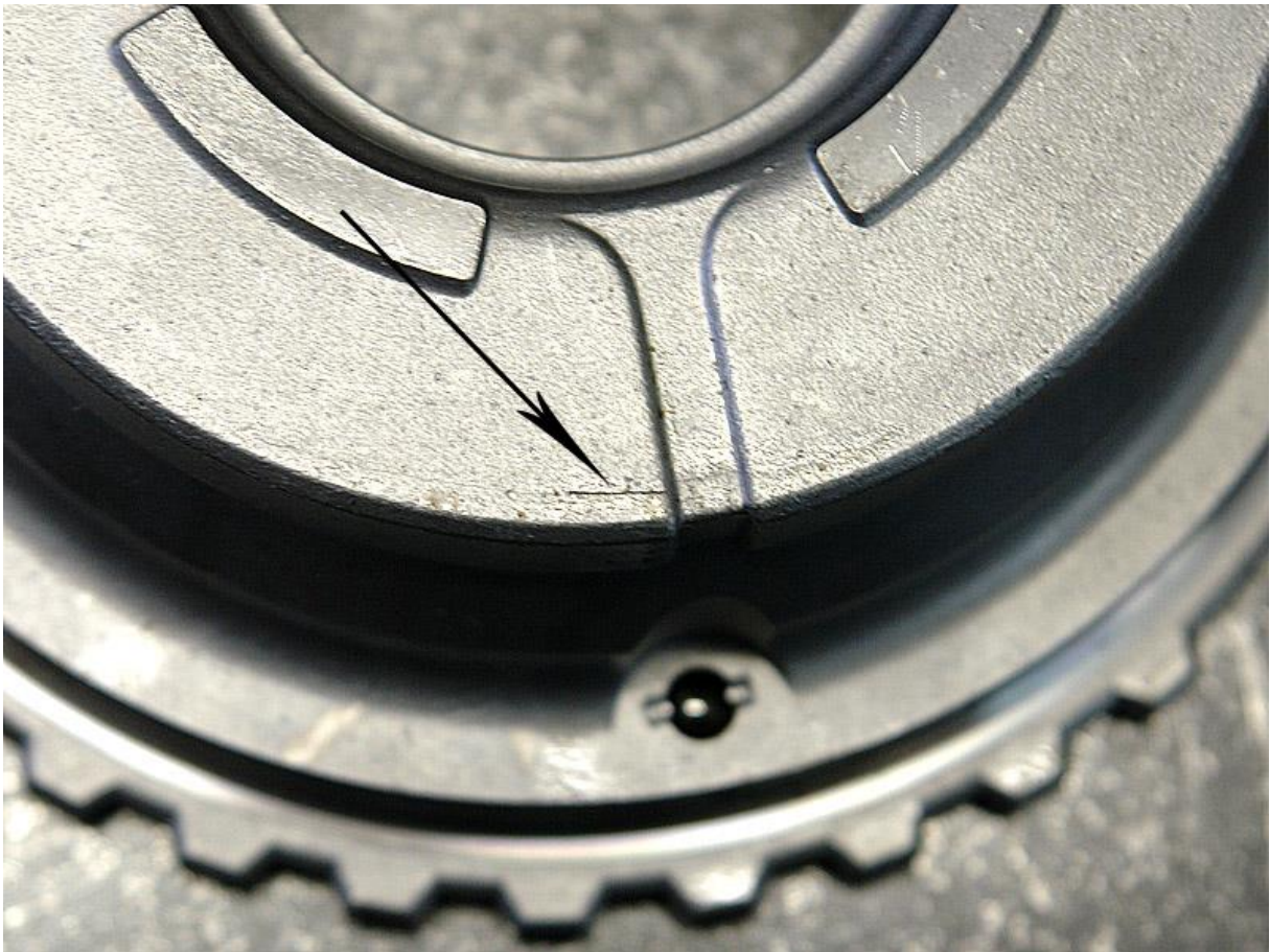
Фото № 20: Поршень сцепления K2 (стрелка указывает на трещину).
