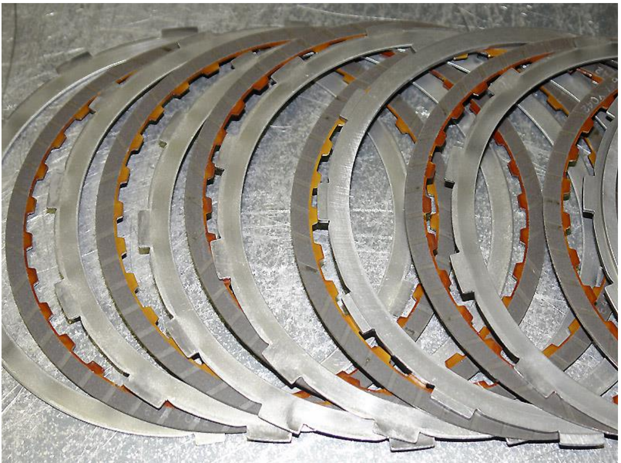
Фото № 8: Пакет фрикционных дисков тормоза B1 (вкл. на передаче заднего хода).
