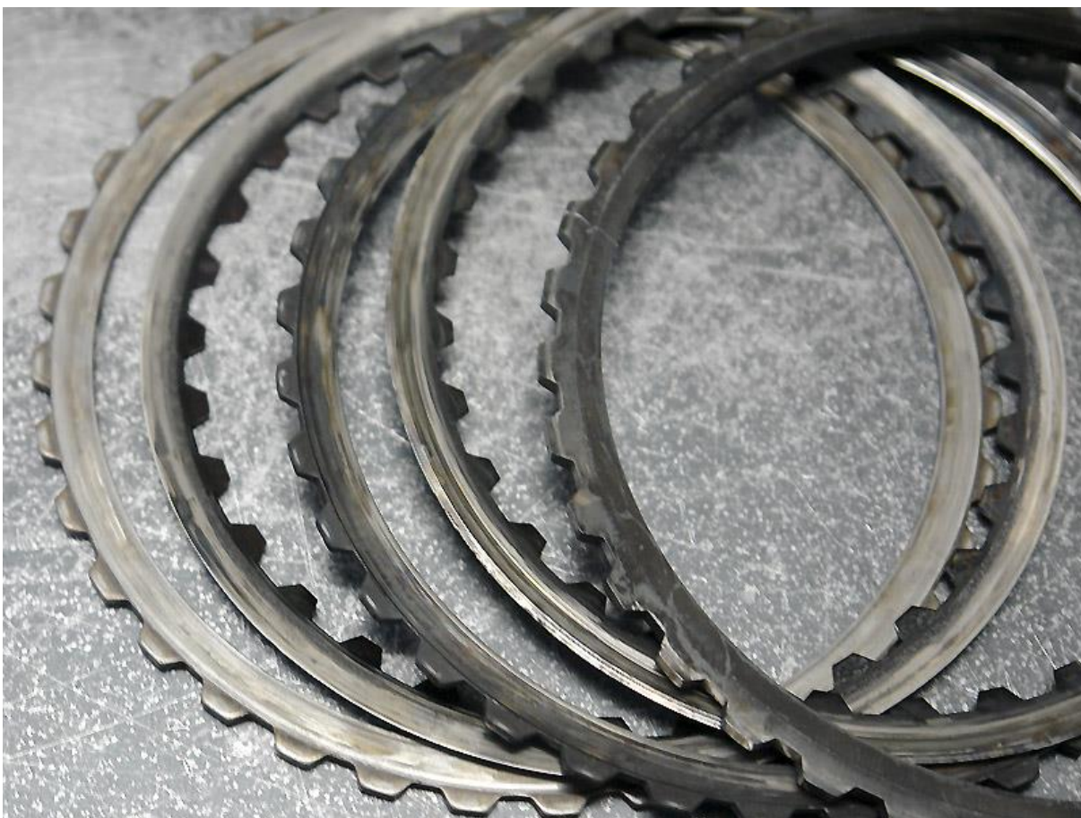
Фото № 5: Пакет фрикционных дисков сцепления K2 (вкл. на передаче заднего хода).
