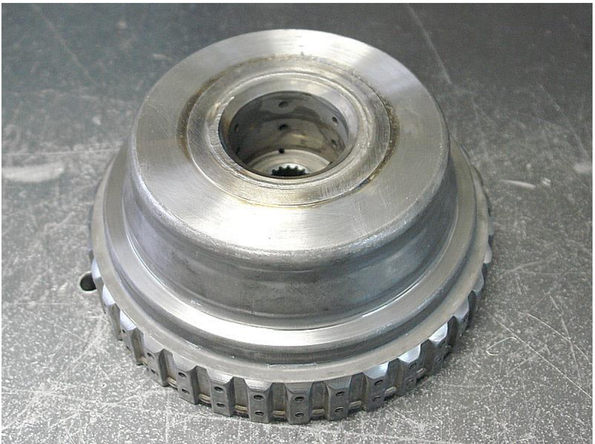
Фото № 16: Корпус сцеплений К2/К3.
