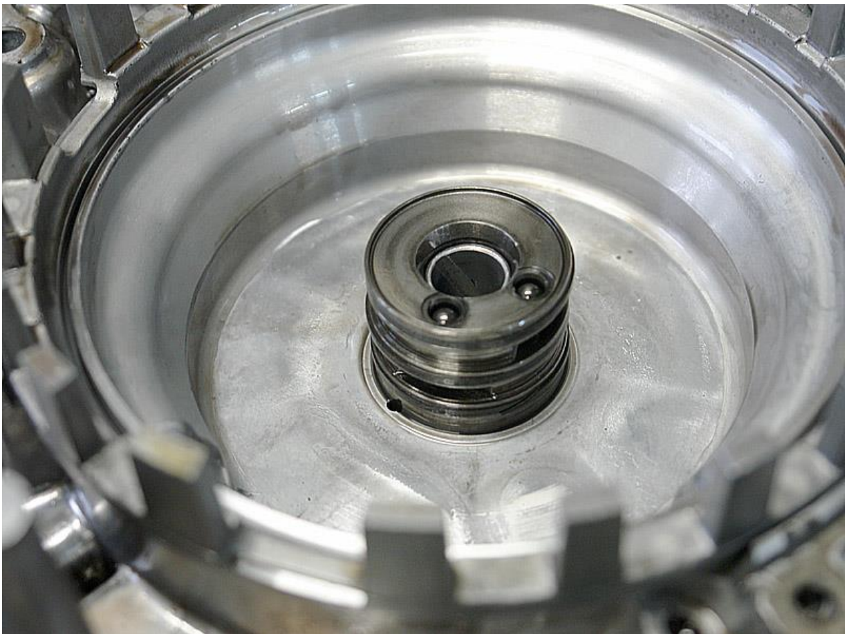
Фото № 14: Уплотнительные кольца корпуса сцеплений K2/K3 в задней крышке.
