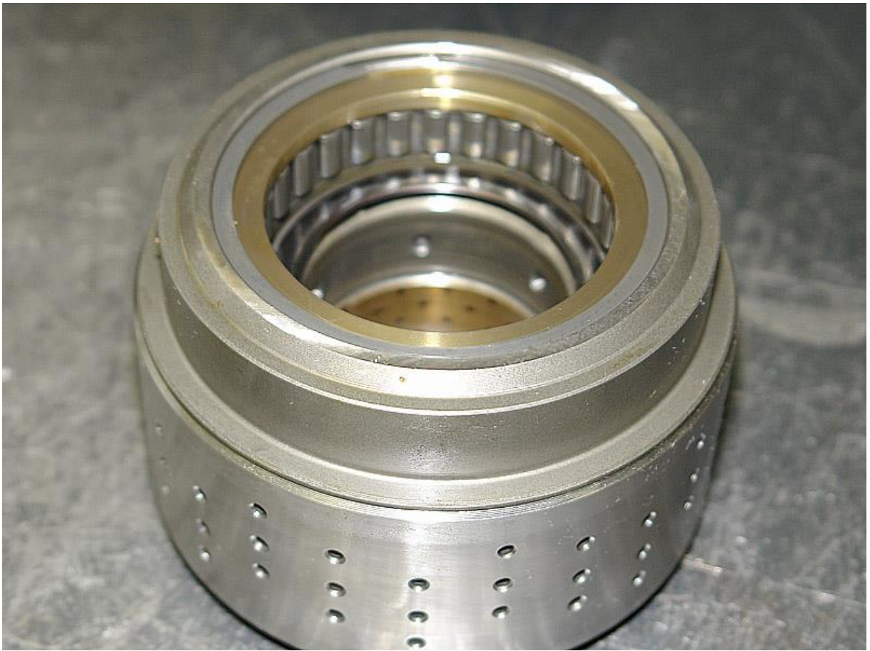
Фото № 17: Корпус сцепления К4 в сборе с кулачковым сепаратором муфты свободного хода.
